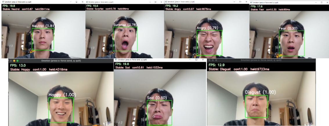
그림 4. FER 모듈을 활용한 실시간 표정 기반 감정 분류 결과 예시
